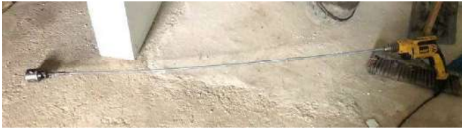
Caladora casera de EPS: Varilla roscada soldada con mecha de copa
